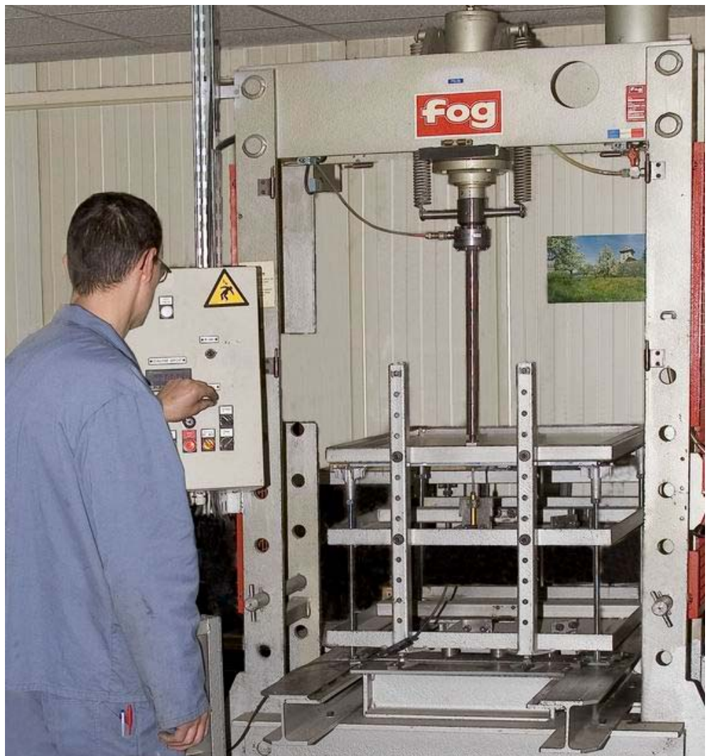
Un essai de charge réalisé sur le banc d'essai.
