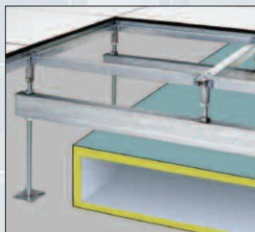
Les fers de franchissement sont utilisés lorsque le plancher surélevé doit être construit au-dessus de conduits, trémies, gaines ou caissons de dimensions importantes.
